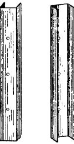
Рис. 41. Шаблоны для заметки и прохода отверстий в боковых планках рамок.
