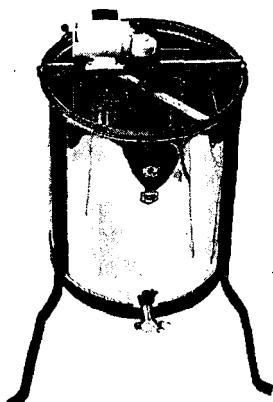
Рис. 17. Радиальная медогонка с электродвигателем
